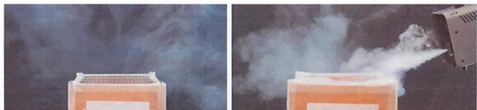
図 3.3 フォグマシンの気流可視化
