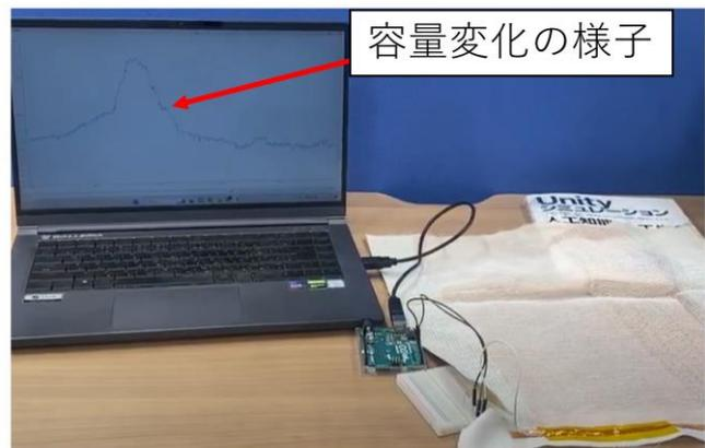
図2 センサ配線を用いた人の検知のメカニズムと静電容量が変化の様子
