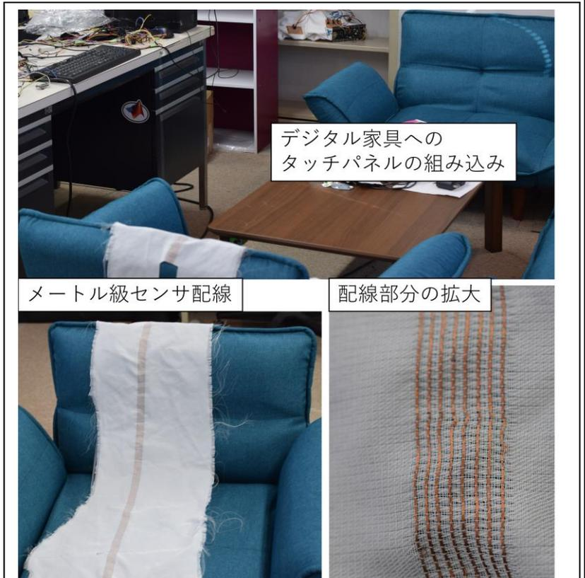
図 1 家具へのセンサ配線の組み込み
