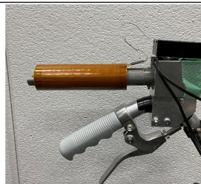
図 2 ハンドル把持時の圧力分布を計測するグリップ
